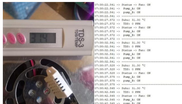
Gambar 7 Pengujian Sensor Suhu dengan alat TDS/TEMP meter
