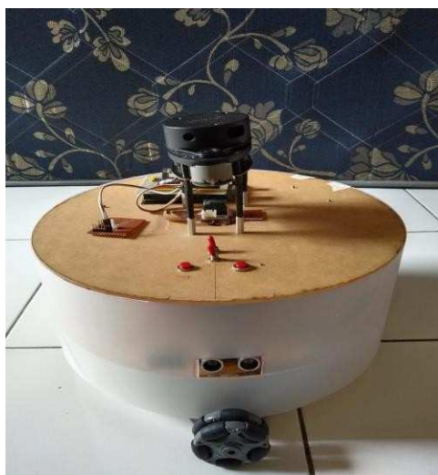
Gambar 4. Hasil perancangan robot pemetaan ruangan dengan penggerak 3 roda
